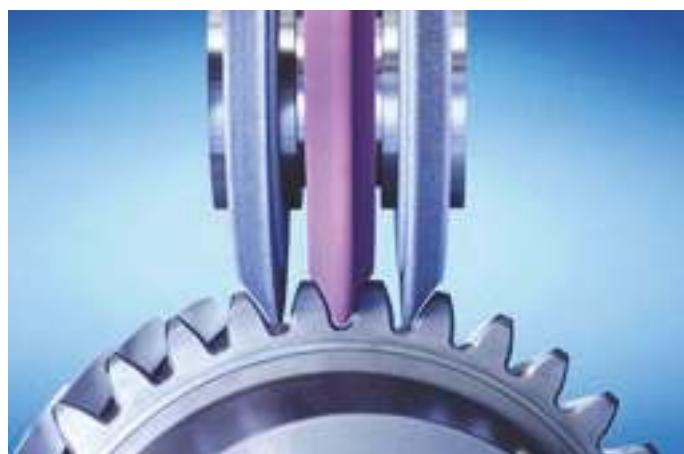
Круги для прерывистого шлифования методом профильного шлифования
