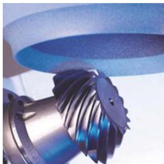
Круги для шлифования спиральных или конических зубчатых колес
