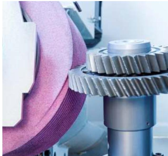
*В зависимости от создаваемого эвольвентного профиля, в первую очередь, следует различать прерывистое (профильное шлифование) и непрерывное зубошлифование (методом обкатки).*
