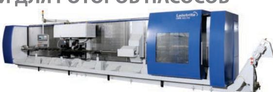
Полировальный станок Leistritz LWN 250 PL – это эффективный способ, гарантирующий необходимое качество финишной обработки для получения идеально отшлифованной поверхности при производстве роторов.
