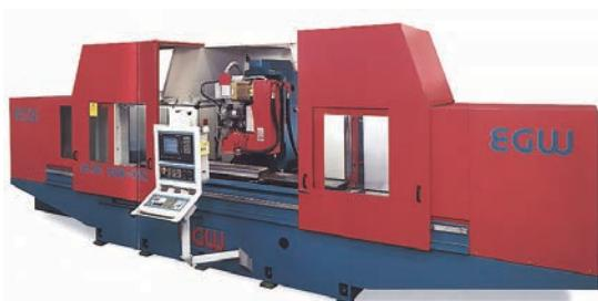
Шлифовальные станки EGW идеально подходят как для маятникового, так и глубинного шлифования. При этом может применяться поперечное или перекрестное шлифование. Перемещение по оси X до 10 метров.
